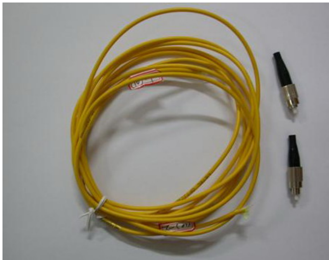
图九、FC型光纤活动连接器抗拉试验后不合格
